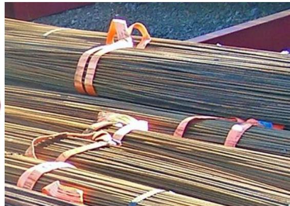
**Slika 1.5. Primer korišćenja jednoslojne kružne trake**
